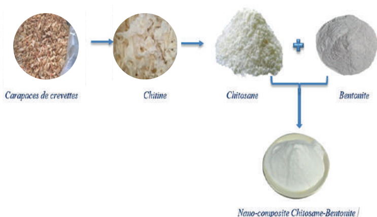
Schéma de préparation de la chitine, du chitosane et du nano-composite Chitosane-bentonite
