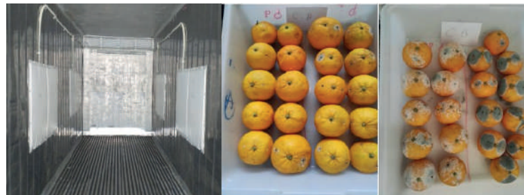
Figure 2 : Vues de l'intérieur du container après installation du système électrostatique (Photo à gauche) et effet sur la sporulation des agents pathogènes (à droite).
